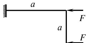
11. Определить вертикальное перемещение сечения А в балке. Жесткость балки на изгиб – EI.
