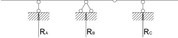
27. Трехпролетная статически определимая балка (см. рисунок) загружена сосредоточенной силой  $F$ . Построить эпюры изгибающих моментов и поперечных сил.
